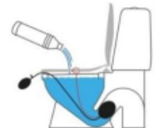
8. Lassen Sie die Entkalker-Mischung 30 Minuten bis 2 Stunden (oder über Nacht) einwirken. Wiederholen Sie die Behandlung für besonders starke Ablagerungen oder lassen Sie die Lösung länger einwirken.
