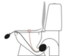
7. Füllen Sie die Toilettenschüssel etwa zur Hälfte mit heissem Wasser. Bevor Sie weiterfahren, müssen Sie sicherstellen dass der Wasserspiegel nicht sinkt. Warten Sie dazu ein paar Minuten. Geben Sie etwa 1/4L Spezial-WC-Entkalker hinzu. Füllen Sie dann die Toilettenschüssel mit heissem Wasser aus dem Wasserhahn.
