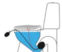
7. Nach der Behandlung **halten Sie die Sicherheitsschnur und den Schlauch gut fest.** Heben Sie den Toilettensitz an und drücken vorsichtig auf das Entlüftungsventil. Wenn das Wasser abgelassen wird, besteht möglicherweise ein starkes Teilvakuum. **Halten Sie daher die Sicherheitsschnur und den Schlauch gut fest.**
